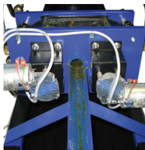
Laufrichtungs- und drehzahleregelter Motor 24 V DC.
